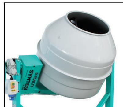
Al eliminar sobre las hormigoneras tradicionales los principales componentes mecánicos: corona de rotación de la cuba, piñón de ataque a la corona, polea motriz y carcasa de basculación con volante mediante registros, ésta ofrece la máxima seguridad para el operario y el mínimo mantenimiento. La ausencia de engranajes mecánicos externos, reduce su rumorosidad hasta 72 dB(A). Se ve girar la cuba pero no se la oye.
