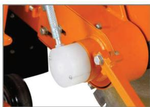
Refrigeración por agua a través del eje del disco.
