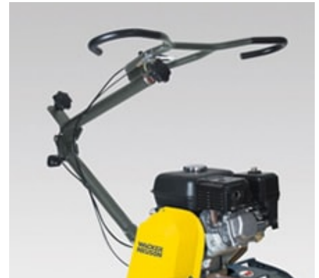
Manillar de guía estándar ajustable y barra de mando plegable, para facilitar su transporte
