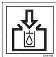
Llenado de depósito de aceite hidráulico
