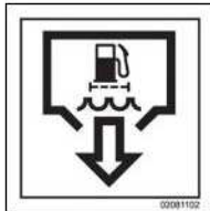
Vaciado de depósito de agua de filtro de combustible
