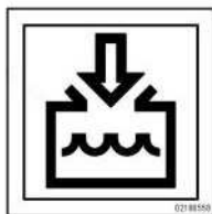
Llenado de depósito de agua
