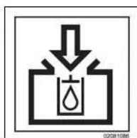
Llenado de depósito de aceite hidráulico
