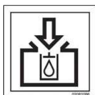
Llenado depósito de aceite hidráulico
