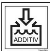
Llenado de depósito de agua de rociado de aditivo
