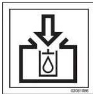
Llenado de depósito de aceite hidráulico
