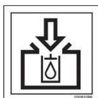
Llenado depósito de aceite hidráulico
