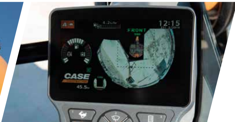
Grupo del monitor LCD a todo color de 7": vista de halcón de 270°
